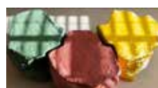
GyPulp Material hecho en Londres con recortes de papel de consumo y yeso reciclado
