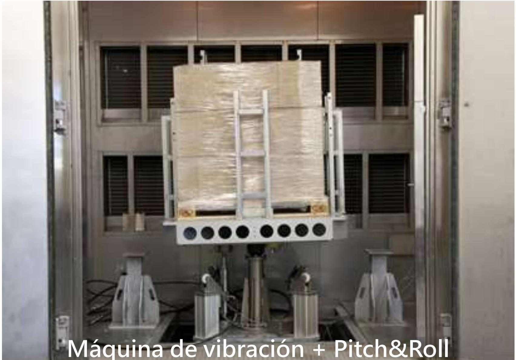
Máquina de vibración + Pitch&Roll
