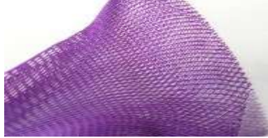
Malla más flexible Mezcla PLA+PBAT+PBS
