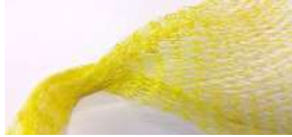
Malla más rígida Mezcla PLA+PBAT+PBS
