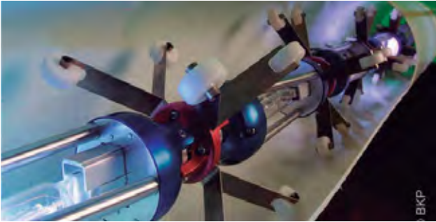
Rehabilitación de tuberías mediante luz ultravioleta Hidrotec En la categoría de Proyecto y/o Servicio Innovador
