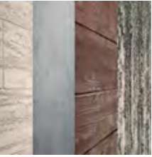
Oikos, S.R.L. TRAVERTINO ROMANO es un mortero de cal hidratada realizada con componentes naturales obtenidos a partir de residuos de otras producciones (canteras de piedras y mármol) y agua purificada como disolvente natural, que se convierte en una piedra caliza, similar al travertino, pero personalizable en el acabado.
