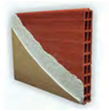
Ceranor (Grupo Resnova) Ladrillo de gran formato Megabrick, trasdosado directo con placa de yeso laminado mediante pasta de agarre. El resultado es un sistema de tabiquería seca, paredes planas y robustas con un acabado perfecto y mejora del aislamiento acústico e inercia térmica.
