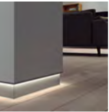
Emac® Complementos, S.L. Novorodapie® Eclipse: gracias a su geometría, el perfil protege el canto inferior de la placa de yeso y queda instalado haciendo un retanqueo en la zona inferior de la pared, lo que genera un efecto innovador de pared suspendida. También puede instalarse como remate superior de pared.
